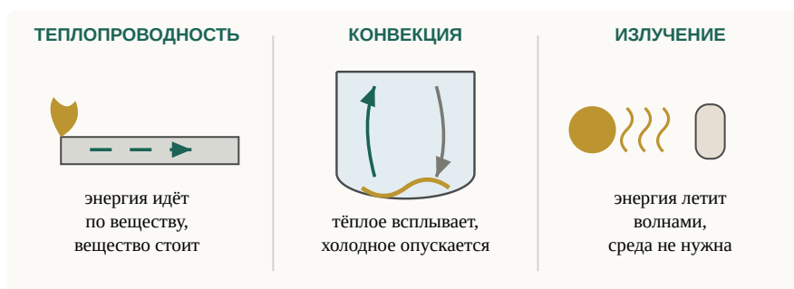
Три вида теплопередачи
